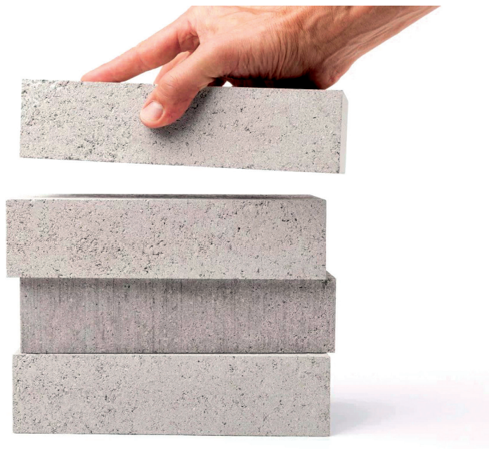
Figura 3: Ladrillo de residuos de Gante
